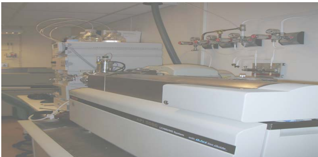
Fig 4 Kromatografen är den höga delen längre bort. Masspektrometern är den avlånga delen.
